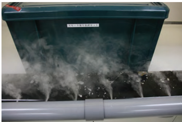
図一5 開口前面に装置等有る時の気流
