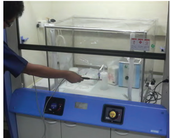
図一1 局所排気装置検査風景
