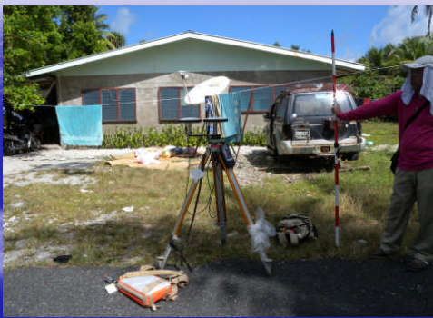
縦断測量におけるGPSの基地点
