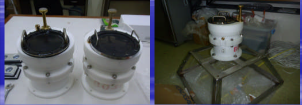
波高計: 波の高さを測定して海流などの情報を得る
