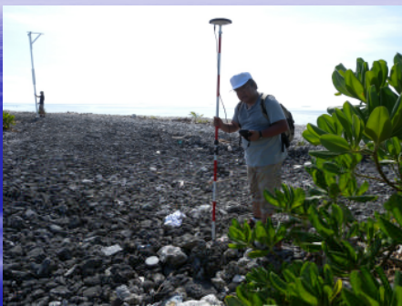
縦断測量と横断測量の共通測点
