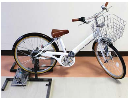
写真2：自転車型発電機
