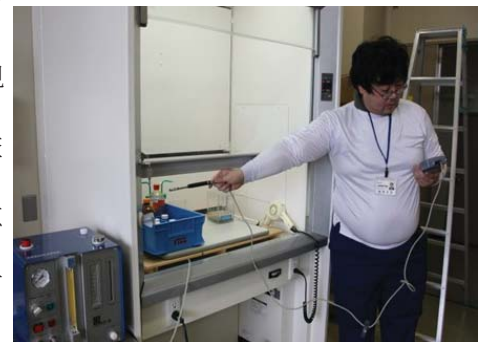
流速の測定(室内)
