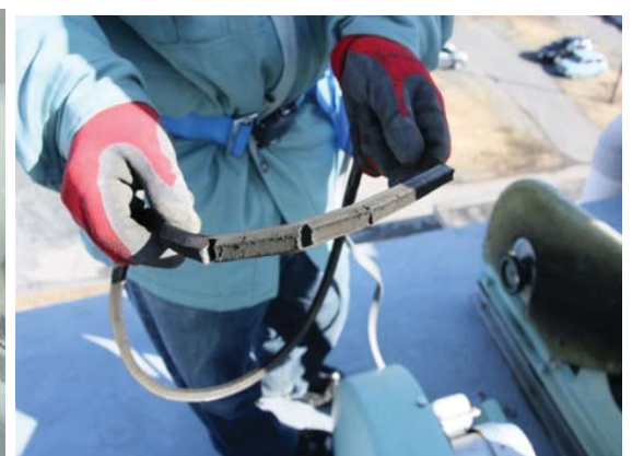
ベルトのひび割れ(屋上)
