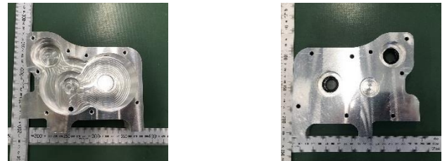
図 2 ギヤボックスケース（左：箱 右：蓋）
