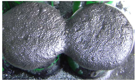
溶融スラグ微粉末の中に存在するアルミニウムとアルカリが反応し、ガス(主に水素ガス)を発生させる
