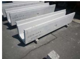
上図 三和コンクリート工業株式会社が溶融スラグ骨材を用いたコンクリート二次製品の作成に取り組んでいる。
